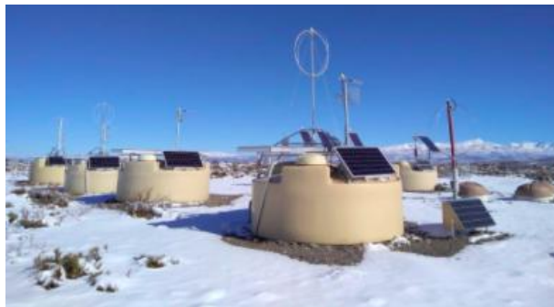
Figura 7. Estaciones del SD mostrando el WCD, SSD y el RD.
